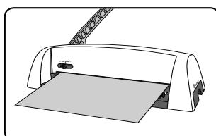
1. Introducir completamente las hojas en la ranura de perforación. Alinear las hojas con la guía para borde.
