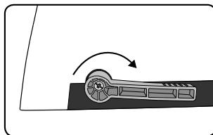
3. S'assurer que le mécanisme d'ouverture de peigne est fermé.
