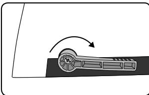
3. Vergewissern Sie sich, dass der Mechanismus, der den Binderücken öffnet, geschlossen ist.
