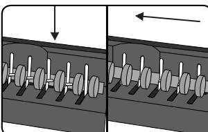
2. Setzen Sie den Binderücken in den Öffnungsmechanismus ein und fahren Sie an die Öffnungsplatte, in dem Sie den Binderücken nach links schieben.
