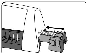
2. Levante el asa de la perforadora. Compruebe que la bandeja de residuos está vacía y montada correctamente.
