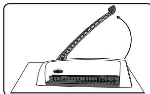
1. Veiller à ce que la machine repose sur une surface stable. Relever la poignée de perforation à la verticale.
