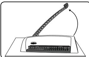
1. Vergewissern Sie sich, dass das Gerät auf einer sicheren und stabilen Fläche steht. Heben Sie den Stanzhebel in die senkrechte Position.
