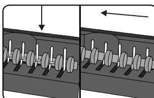
2. Colocar el canutillo de encuadernación en el mecanismo de apertura y enclavar a tope la placa de apertura, deslizando el canutillo hacia la izquierda.
