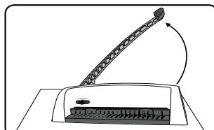
1. Asegúrese de que la máquina se encuentra sobre una superficie estable. Levante el asa de la perforadora hasta su posición vertical.
